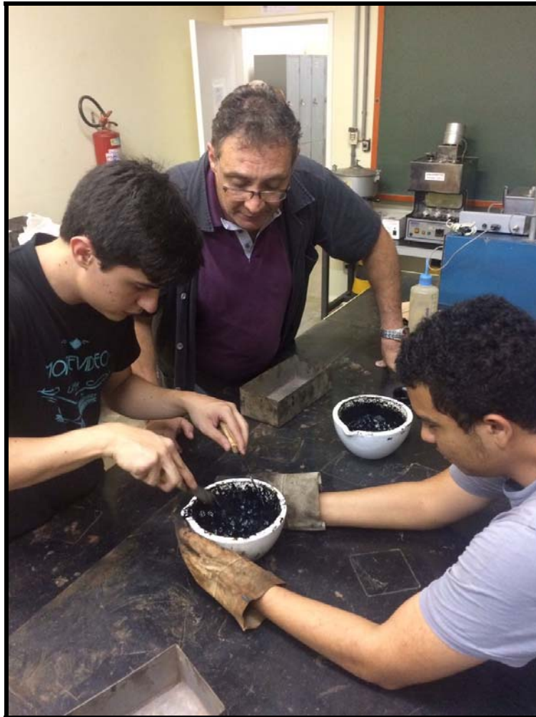
Figura 03 – Avaliação da adesividade do agregado ao ligante betuminoso (CAP 150-200).
