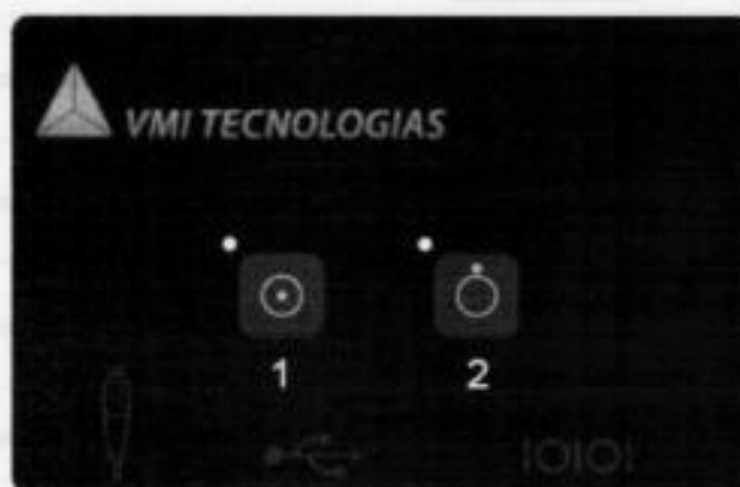
Figura 36- Painel de Comando (Ligar Equipamento)
