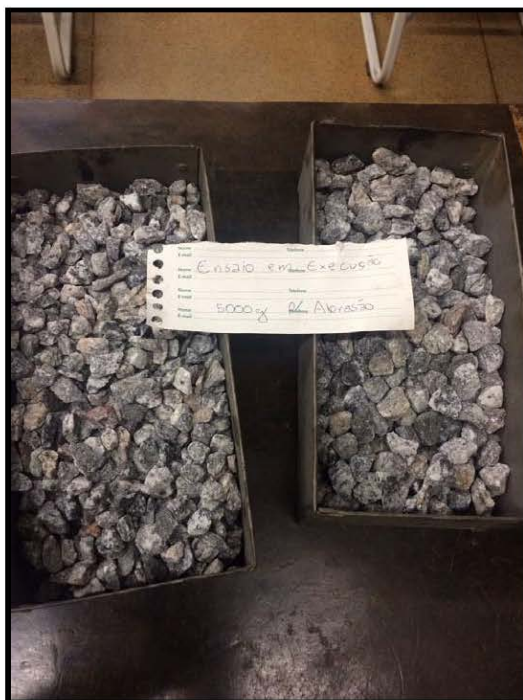
Figura 01 – Agregado graúdo preparado para o ensaio de abrasão Los Angeles.
