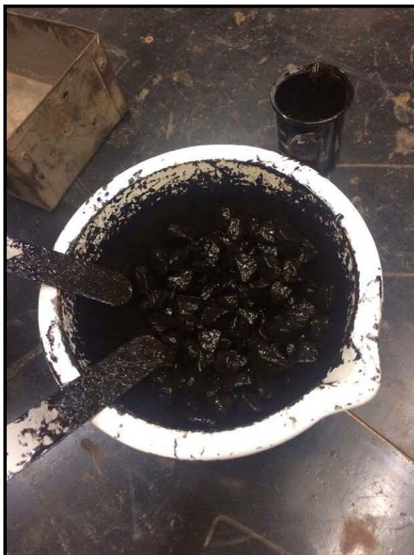
Figura 04 – Avaliação da adesividade do agregado ao ligante betuminoso emulsão asfáltica RR-2C.
