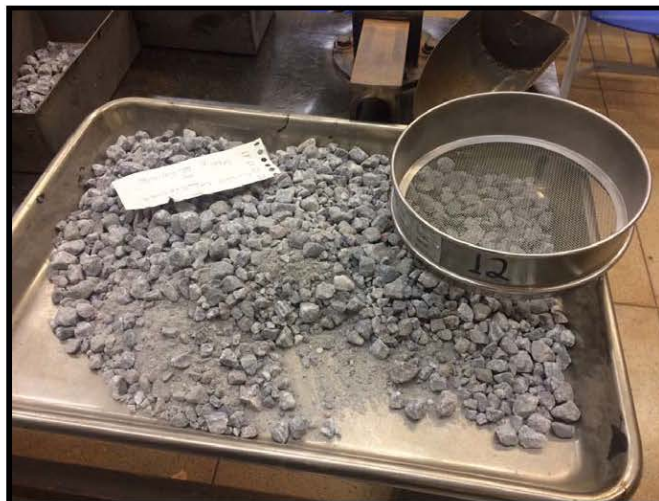
Figura 02 - Agregado que foi submetido ao processo de abrasão.
