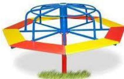
Fabricado com tubos de aço carbono de no mínimo 2” x 1,50mm. Metalão de aço carbono de no mínimo 30 mm x 50 mm x 2 mm e chapa de aço carbono de no mínimo 2mm. Utiliza-se tratamento de superfície a base de fosfato, película protetiva de resina de poliéster termoendurecível colorido com sistema de deposição de pó eletrostático, solda MIG e rolamentos.
