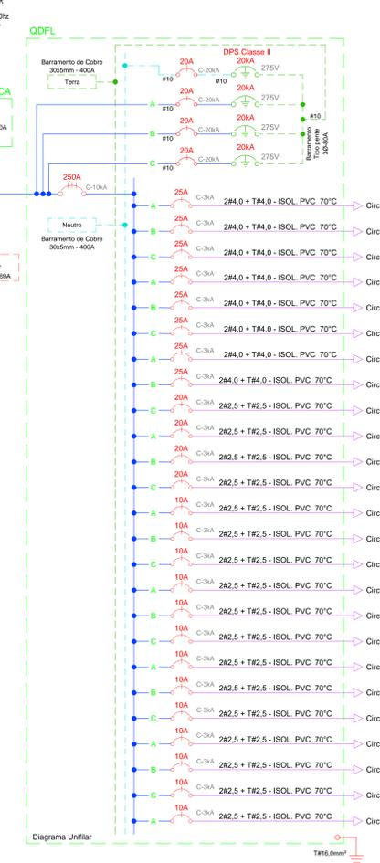
Observação: Todos os circuitos constantes no QDFL deverão seguir as orientações iniciais do Projeto Elétrico original da Edificação. É importante ressaltar que este diagrama unifilar apresenta a alocação somente da entrada de energia do painel visando o aproveitamento máximo do GMG a instalar.
