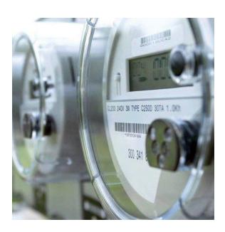
Figura 7 – Dispositivo da Advanced Metering Infrastructure. Fonte: Eaton (2023)
